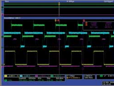
Der Jitter beträgt 25 Nanosekunden, die allerdings systembedingt sind. Abgebildet ist ein Ausschnitt aus dem Signalspiel der Steuerung mit der Laserhardware.
